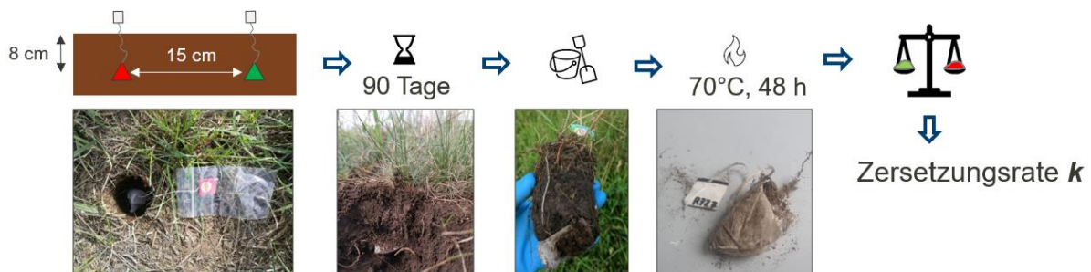
Abb. 6: Experimentelle Erfassung des Streuabbaus mit Hilfe des „Tea Bag Index“. Vorausgewogene Teebeutel mit grünem sowie Rooibostee werden für 3 Monate in 8 cm Tiefe vergraben. Anschließend wird der Masseverlust des Tees bestimmt und damit die Zersetzungsrate berechnet.
