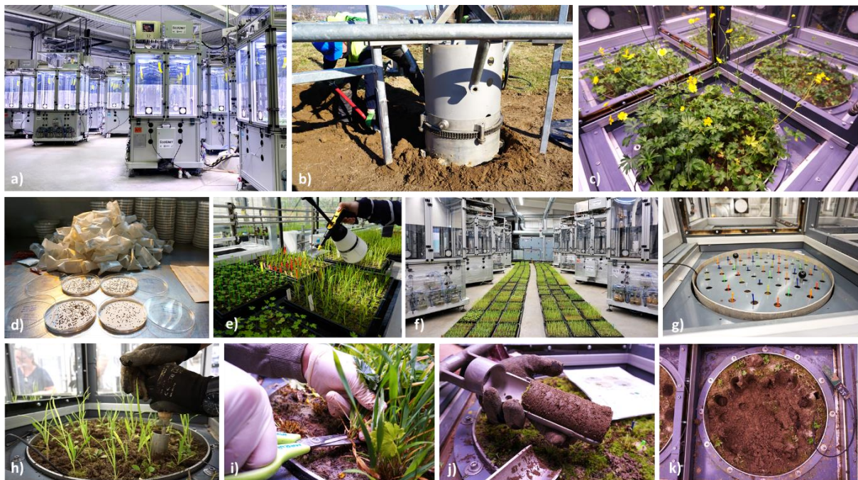
Abbildung 2: Etablierung des JENATRON-Experimentes im iDiv-Ecotron: a) Foto von einigen EcoUnits in der Ecotron-Halle. b) Gewinnung intakter Bodenmonolithe im Jena-Experiment. c) Foto von vier Lysimetern in einer EcoUnit mit Innenwänden. d) Foto von der Aussaat des Saatguts in Petrischalen. e) Foto nach dem Pikieren der Pflanzen in plot-spezifischen Boden in 96-Quickpot-Platten. f) Foto aller Individuen, die im Rahmen des JENATRON-Experimentes gepflanzt wurden. g) Foto der artspezifischen Markierung der Positionen aller Pflanzen auf den Monolithen mit Hilfe einer speziell angefertigten Pflanzschablone. h) Foto der Bepflanzung aller Bodenmonolithe mit Hilfe von Zwiebelpflanzern. i) Foto der Ernte der oberirdischen Pflanzenbiomasse. j) Foto der Bodenprobenahme. k) Foto eines komplett beprobten Lysimeters.
